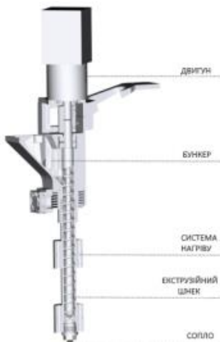
Рисунок 15 Схема екструдера з можливістю друку класичного екструдера.
