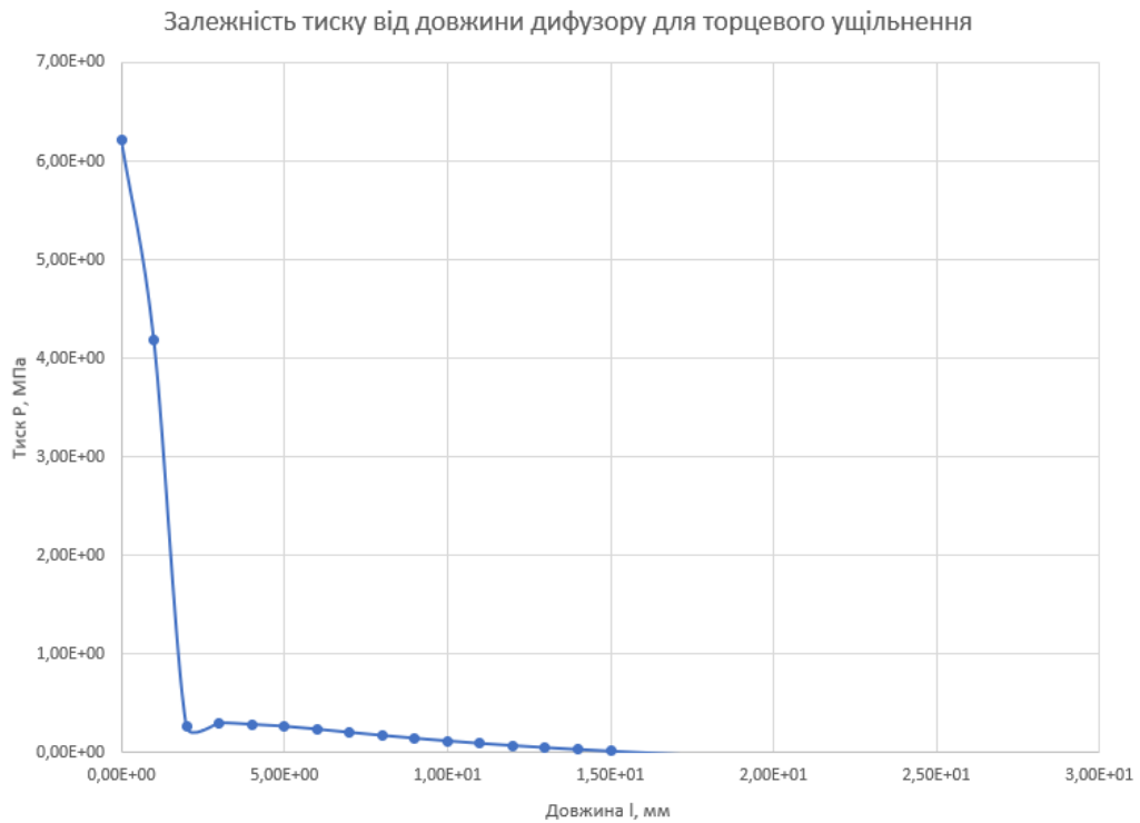
Рисунок 4.5 – Графік залежності тиску від довжини для дифузору торцевого ущільнення
