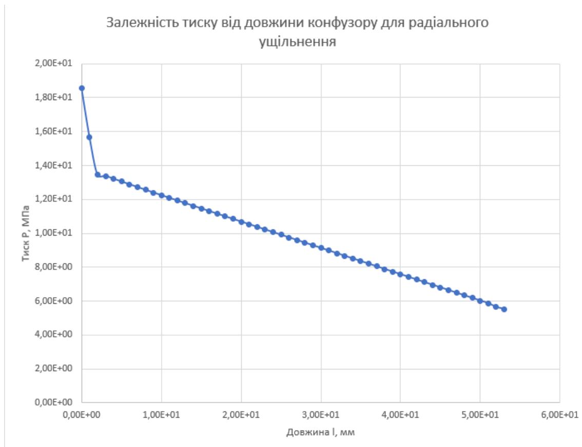
Рисунок 4.1 – Графік залежності тиску від довжини для конфузору радіального ущільнення
