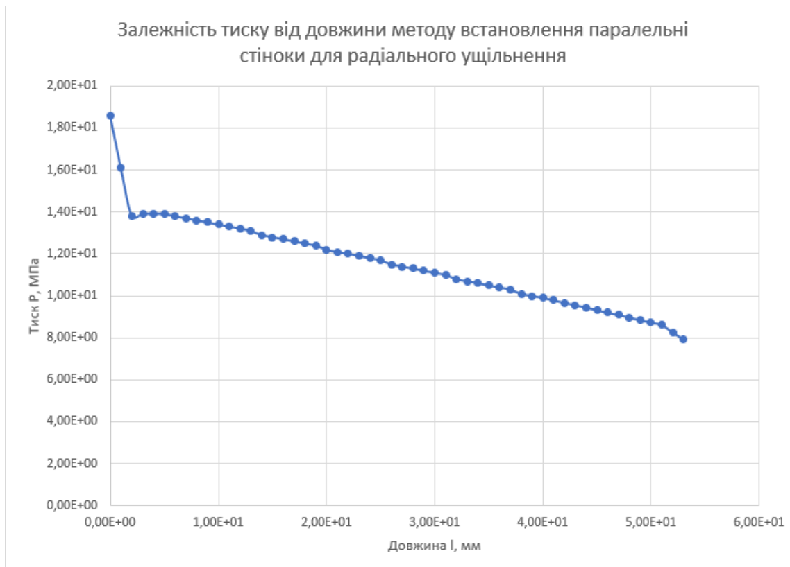
Рисунок 4.3 – Графік залежності тиску від довжини для паралельних стінок радіального ущільнення
