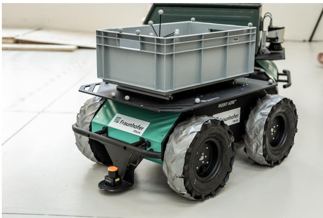
Рисунок 1.2 – Husky A200 - мобільна роботизована платформа, призначена для автономного виконання логістичних завдань на будівельних майданчиках.
