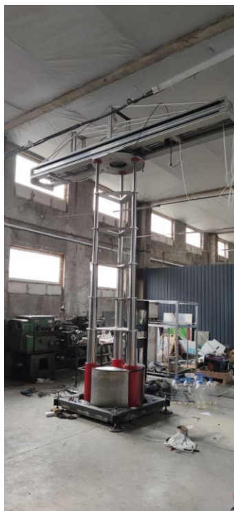
Рисунок 2.2 Прототип будівельного принтера радіального типу
