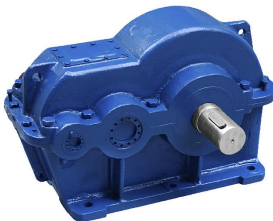
Рисунок 1.2 – Двоступінчастий редуктор компанії «Olava», модель RY-900i
