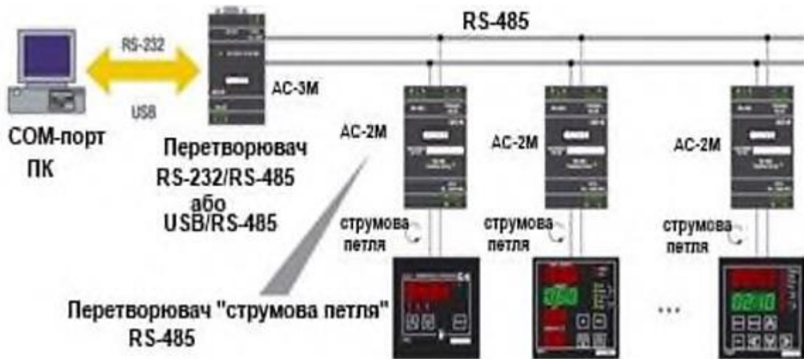
Рис. 3.26 Схема підключення приладів з інтерфейсом «струмова петля» до ПК через перетворювач ОВЕН АС2, ОВЕН АС3-М
