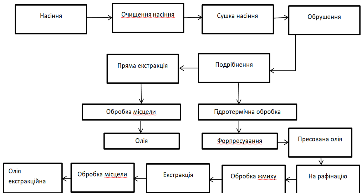
Рис. 1.2 – Схема виробництва соняшnikової олії
