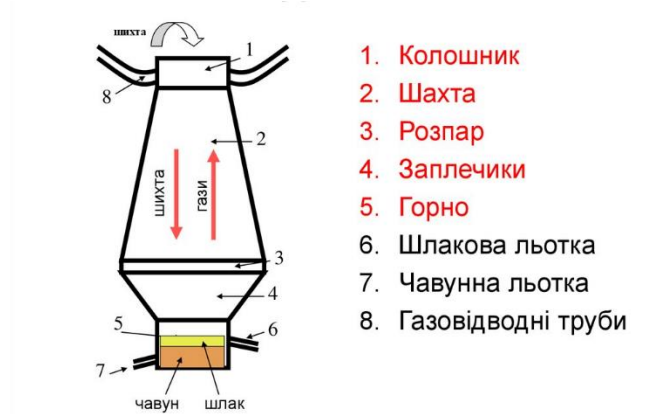
Рисунок 14 – Схема доменної печі
