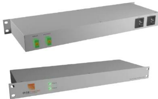
Рисинок 3.4 – Підсилювачі на основі ербієвих волокон (Erbium-Doped Fiber Amplifier, EDFA) [19]
