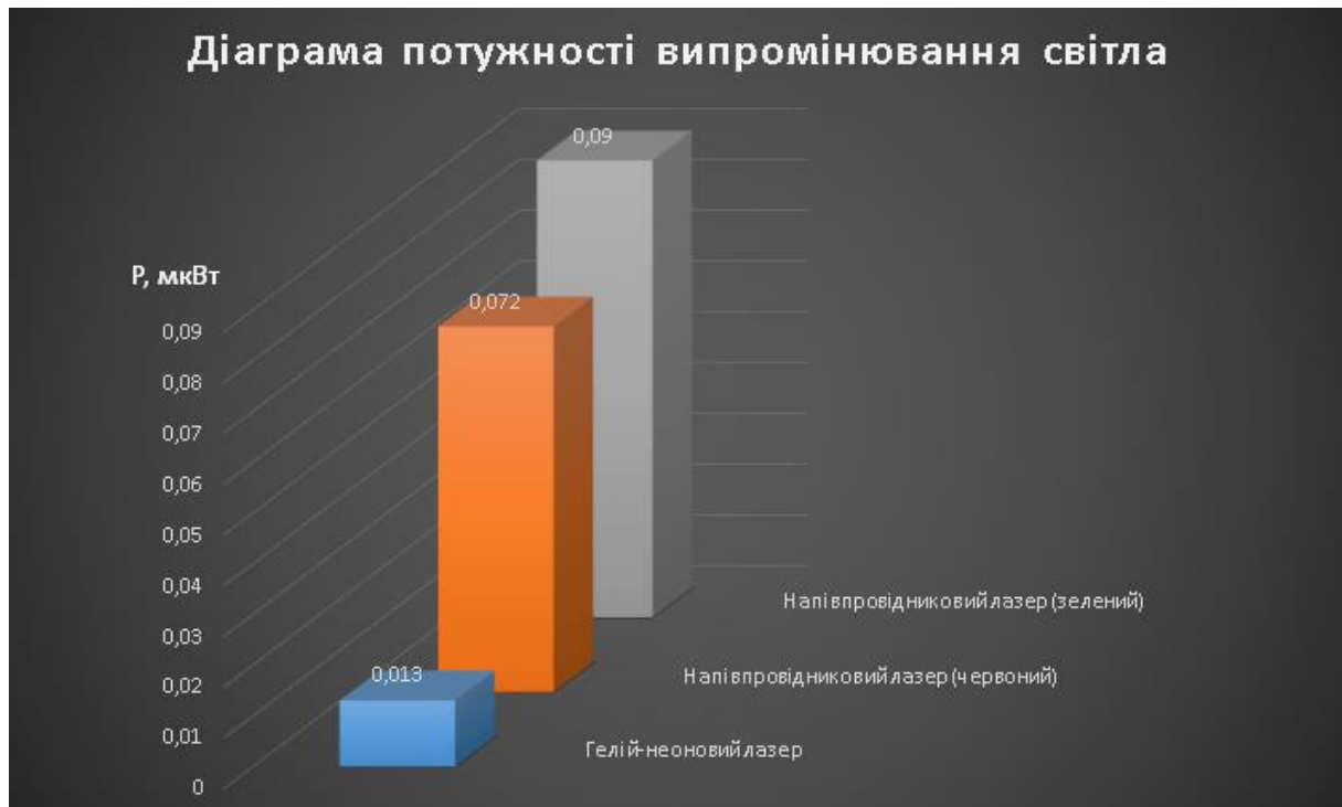
Рисунок 3.5 - Діаграма потужності випромінювання, виміряна виході фотодіоду, що використовується як приймач лазерного випромінювання
