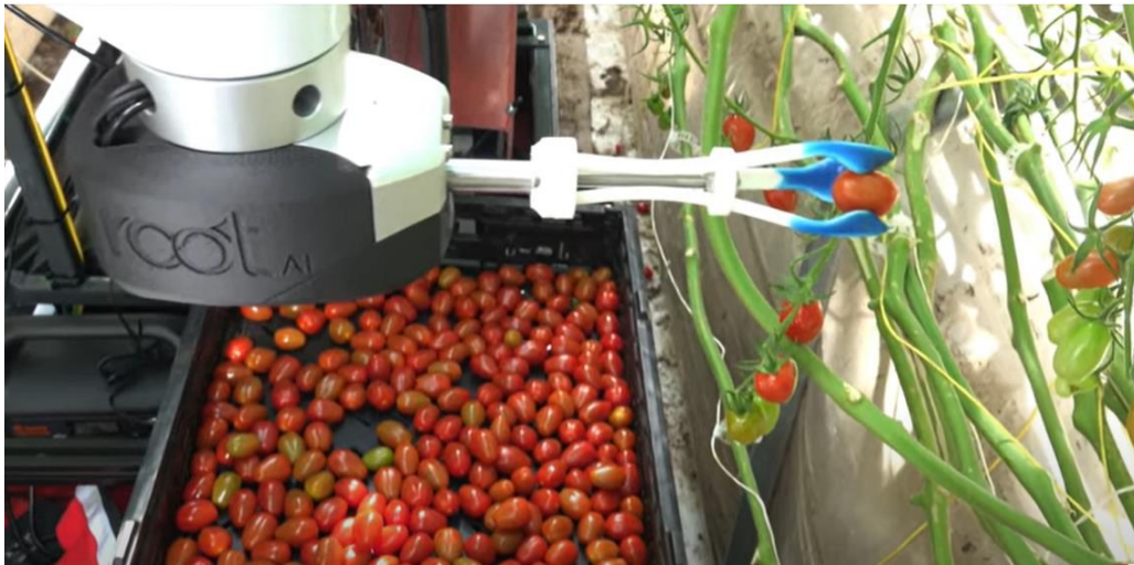
Рисунок 1.16 – Робот-збиральна машина для помідорів [6]
