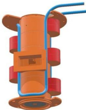
Рисунок 2.3. Лінійний акселератор прискорювача Halcyon [5]
