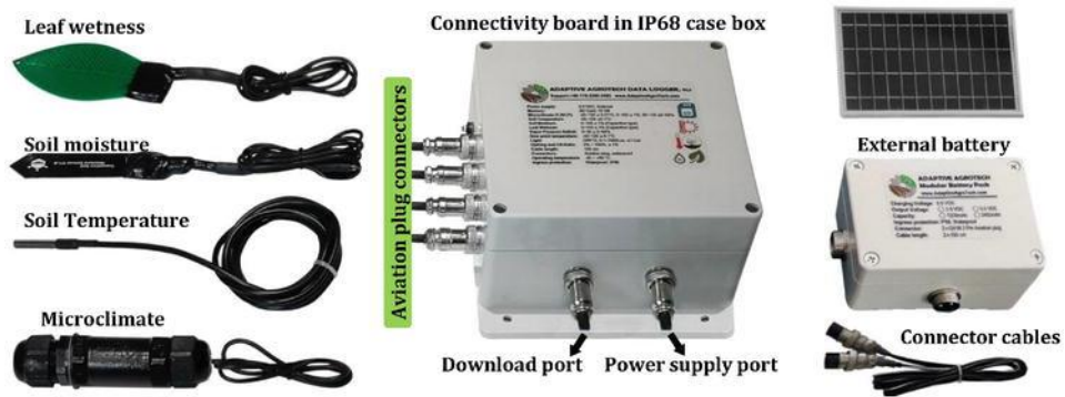
Рисунок 2.12 - Гібридна система збору даних із модульною зовнішньою батареєю
