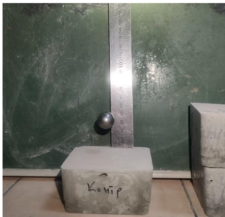
Рисунок 3.13 «Стоп-кадр» сповільненої зйомки: Вимірювання висоти відскоку сталеві кульки еталонного зразку.
