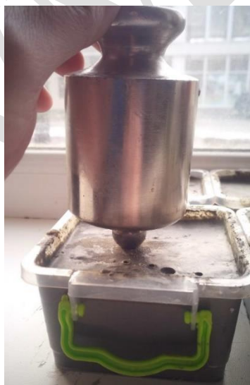
Рисунок 3.11 Випробування на міцність за допомогою сталеві кульки до якої прикладалось навантаження в 2 кілограм-сили.
