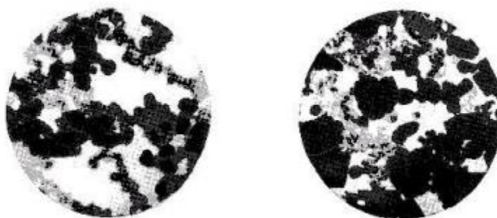
Рисунок 3.9 Мікроструктури портландцементного клінкеру: зліва гідратованого протягом 24 год; справа - 3 доби, х 6000 [5]
