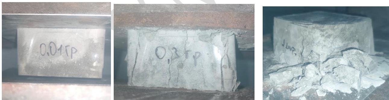
Рисунок 3.15 - Зразки для випробування на стиск: а) – до випробувань, б) - початок руйнування зразку, в) – зруйнований зразок після випробувань
