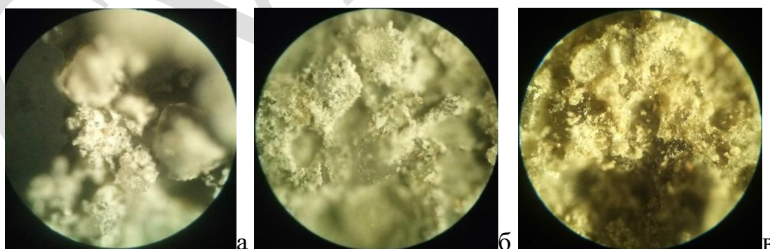
Рисунок 3.16 Мікроструктура еталонного цементного каменю (без нанотруbkового модифікування) через: а) 15 годин б) 37 годин в) 7 діб збільшення, x200
