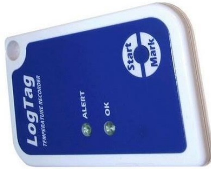
Рисунок 20 - Термоіндикатор Log Tag TRIX-8
