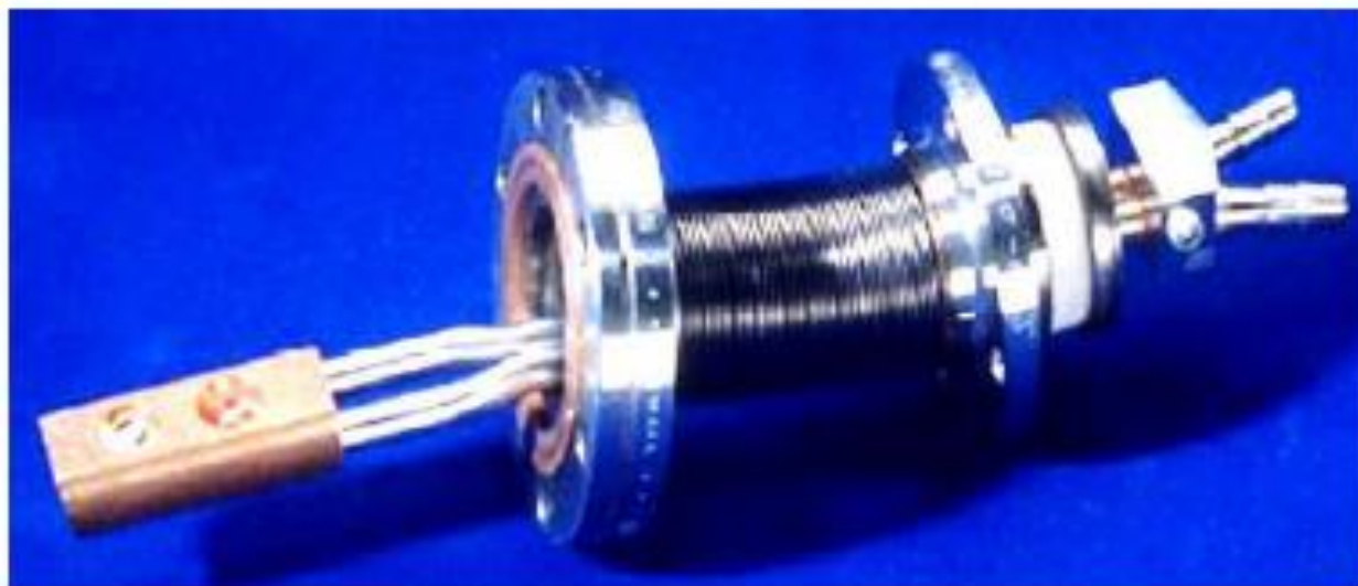
Рисунок 1.4 З'ємна мішень з водяним охолодженням прискорювача VARIAN Clinac-18
