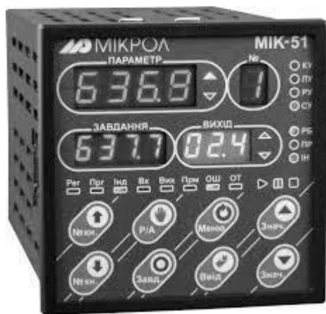
Рисунок 5.8 – Мікропроцесорний контролер МИК 51-07
