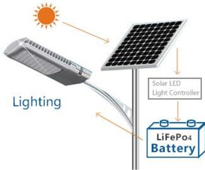
Рис.1.2.1 приклад автономної системи освітлення на сонячних батареях.
