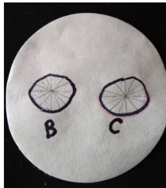
Рисунок 2.14 – Визначення поверхневого натягу слини: В – площа плями дистильованої води; С - площа плями слини
