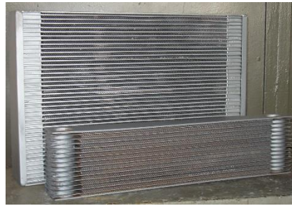
Рисунок 1.4 – Стальний ПРТ зі штампованих проставкових листів з вбудованими колекторами
