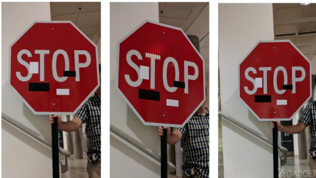
Рисунок 20 – Приклад легкого дефектування знаків
