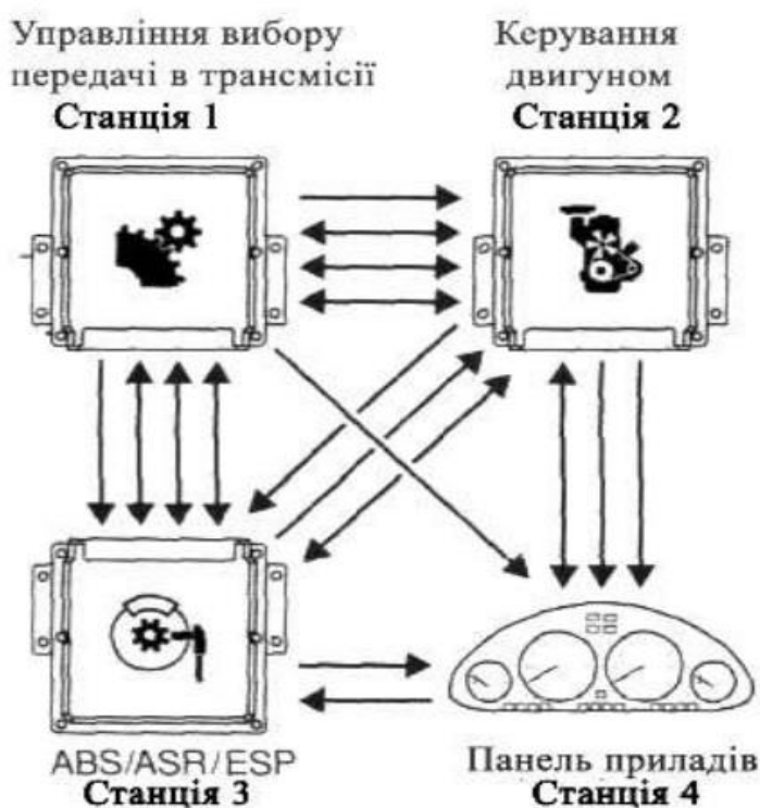
Рисунок 7 – Схема передачі даних CAN
