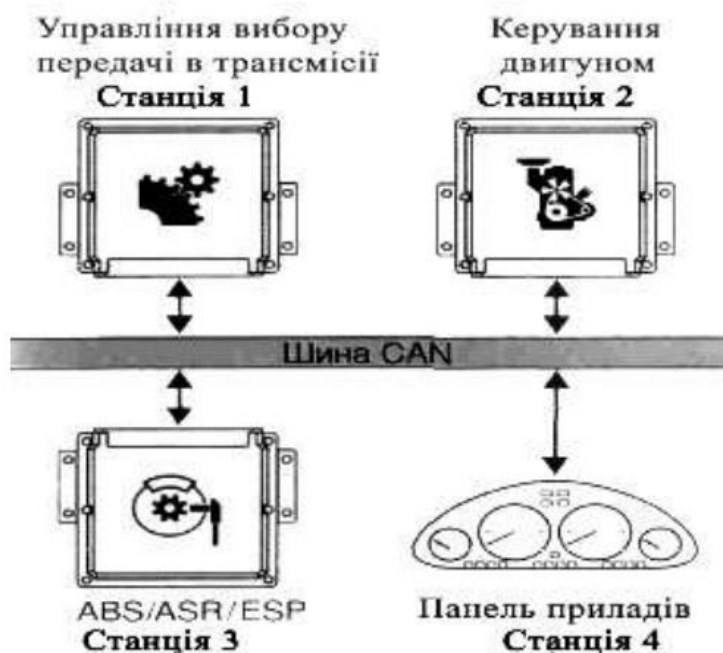
Рисунок 6 – Лінійна структура шини CAN
