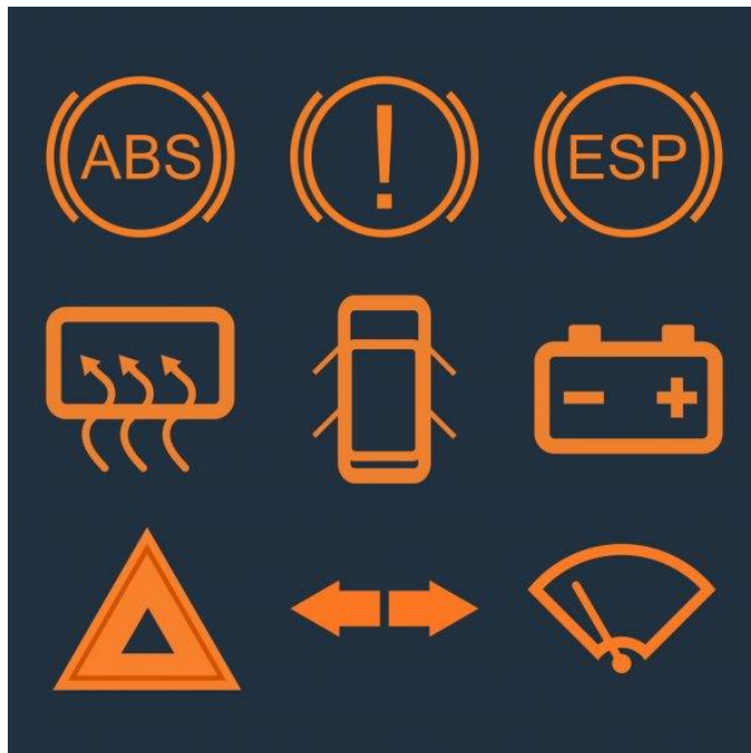
Рисунок 3 – Індикація електронних систем та їх помилок
