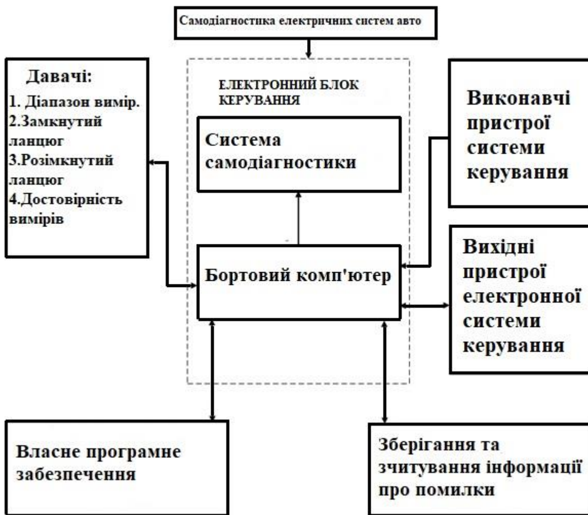
Рисунок 14 – Структурна схема самодіагностики автомобіля
