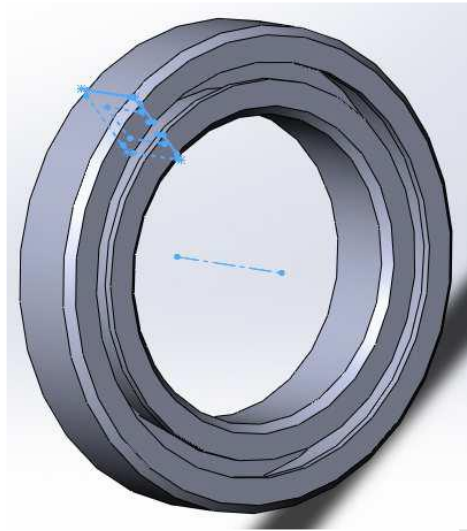
Рисунок 1.3 – 3D CAD модель ущільнювального кільця [8].
