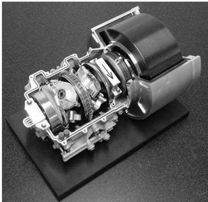
Рисунок 1.3 – Маховик в кінетичній системі відновлення енергії (KERS)
