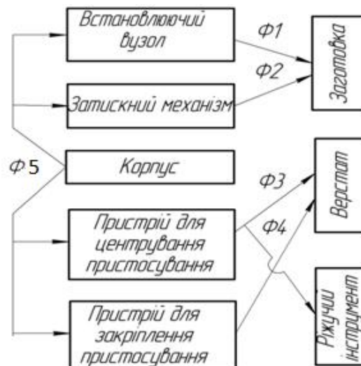
Рисунок 2.16 – Функціональна структура проектованого пристрою
