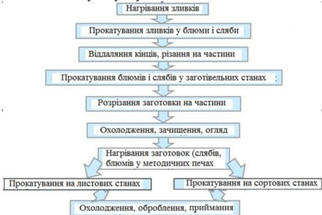
Рисунок 2.1 – Загальна схема технологічного процесу прокатування
