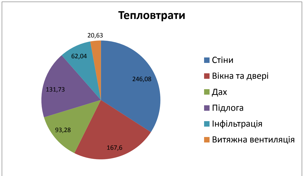
Рисунок 2.1 – Співвідношення теплових втрат через огорджувальні конструкції будівлі та інфільтрацію
