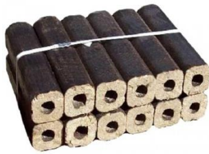
Рис.2.2. Паливні брикети різних: а) РУФ; б) Pini&Kaу в) Нестро
