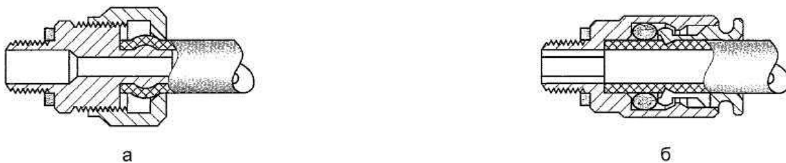
Рисунок 6.22 – З’єднання для гнучких трубопроводів: а – з’єднання з фігурним наконечником штуцера і накидною гайкою; б – швидкокорознімне з’єднання з цанговим затискачем
