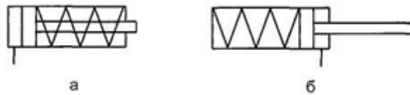
Рисунок 3.3 – Умовні графічні позначення пневмоциліндрів однобічної дії:
