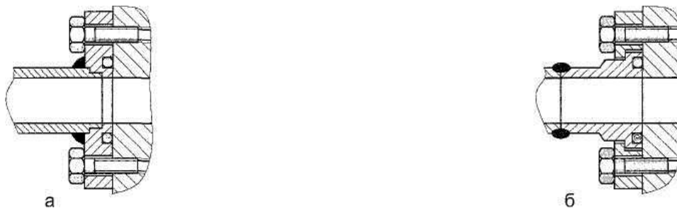
Рисунок 6.20 – Фланцеві з'єднання трубопроводів, що мають: а – плоский приварний фланець; б – накидний фланець
