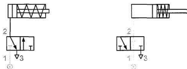
Рисунок 4.4 – Керування пневмоциліндром одnobічної дії 3/2-пневморозподільника
