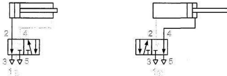
Рисунок 4.6 – Керування пневмоциліндром двобічної дії 5/2-пневморозподільника
