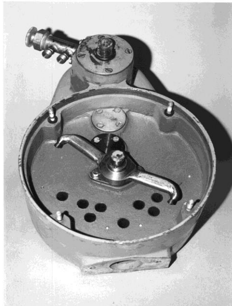
Рисунок 3.30 – Струминно-реактивний пневмодвигун (пневмомотор зі струминно-реактивною турбіною)
