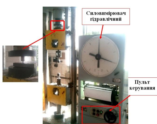
Рисунок 4.5 – Фото проведення експериментального дослідження міцності роз'ємного гвинтового з'єднання з круглою різьбою [100]
