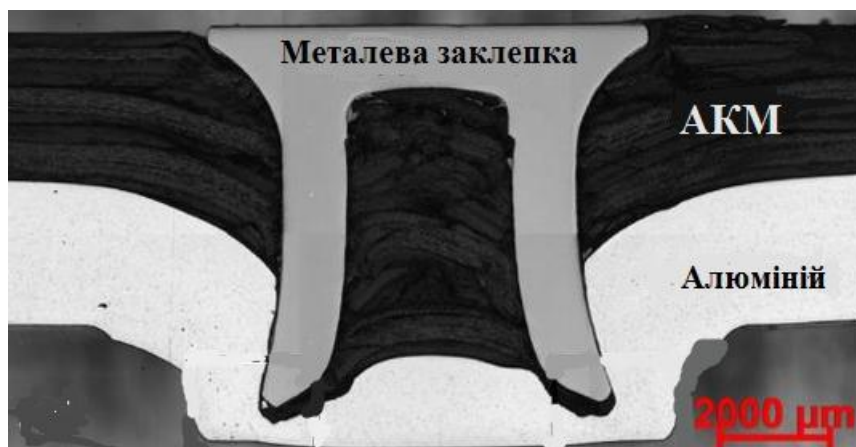
Рисунок 1.6 – З'єднання спеціальною заклепкою АКМ та алюмінію [32]
