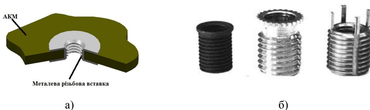
Рисунок 1.14 – Реалізація гвинтового з'єднання в АКМ за допомогою вставки:
