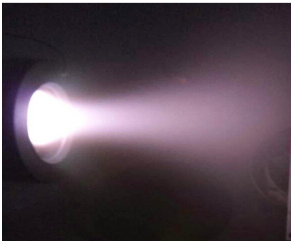
Рисунок 2.2 – Процес розпилення мішені розбалансованим магнетроном
