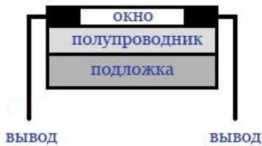
Рисунок 4.5 – Внутрішня структура фоторезистора
