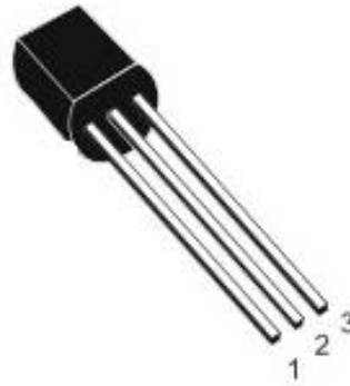
Рисунок 4.2 – Цоколівка та зовнішній вигляд транзистора
