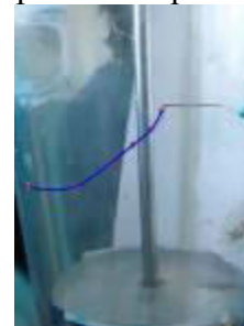
Рисунок 2 – Траєкторія руху краплі при положенні сопла по напрямку руху повітря та витраті повітря 1,4 \cdot 10^{-2} \text{ м}^3/\text{с}
