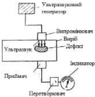
Рисунок 3.46 – Ультразвукова дефектоскопія
