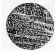
Рисунок 3.13 – Однофазна (до 39 % Zn) лита латунь
