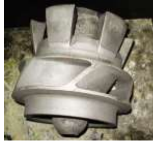
Рисунок 3.1 – Виливок із ливниковою системою, додатками
