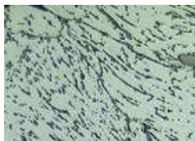
Рисунок 7.27 – КММ – сплав алюмінію AA6061/NiTi.
