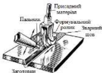
Рисунок 7.37 – Схема зварювання нагрітим повітрям
