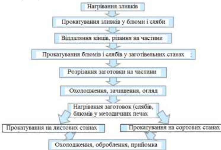
Рисунок 4.27 – Загальна схема технологічного процесу прокатування
