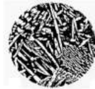
Рисунок 3.14 – Двофазна (вище 39 % Zn) лита латунь
