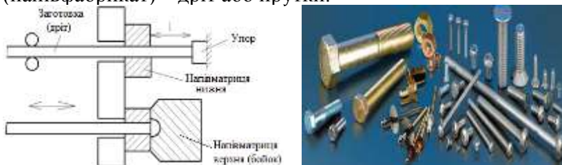
Рисунок 4.46 – Схема штампування висадженням (а) та отримувані заготовки (б)
