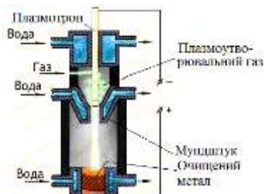
Рисунок 2.13 – Схема плазмового переплавлення металу
