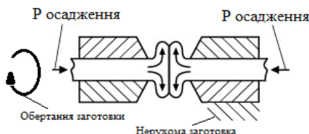
Рисунок 5.29 – Схема зварювання тертям обертанням
