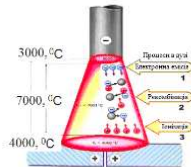
Рисунок 5.5 – Електрична дуга та її параметри
