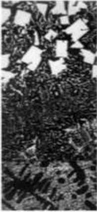
Рисунок 3.4 – Мікроструктура повільно охолодженого зливка за висотою. Сплав свинець-сурма (20 % Sb)
