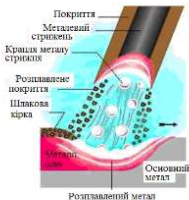
Рисунок 5.9 – Зварювання металевим покритим електродом
