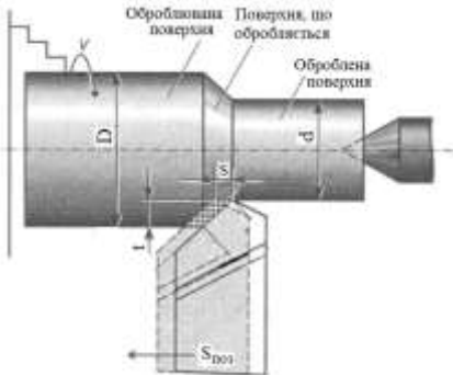
Рисунок 6.2 – Основні параметри процесу різання
