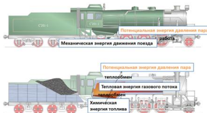
Рисунок – Процессы преобразования энергии в паровозе
